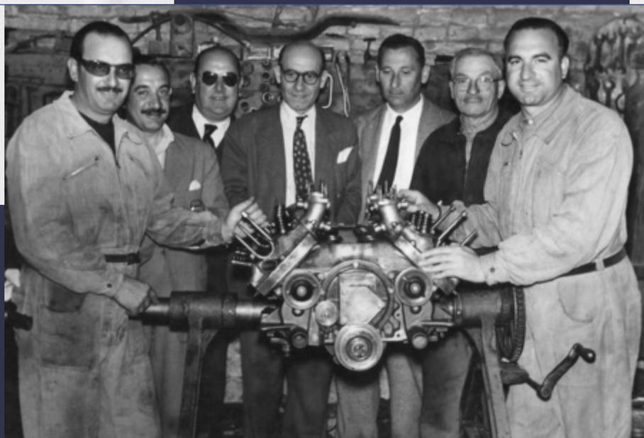
El sistema de **admisión permitía que el motor se alimentara mediante cuatro carburadores duales de marca Ford**, a los que **dos bombas accionadas eléctricamente** enviaban el combustible. El sistema de lubricación fue conservado tal como venía de fábrica. Las bielas eran marca Ford pero **el cigüeñal tenía un volteo mayor que el estándar: llegaba a los 101,6 mm. y el máximo régimen de este motor oscilaba en las 5000 r.p.m.**
