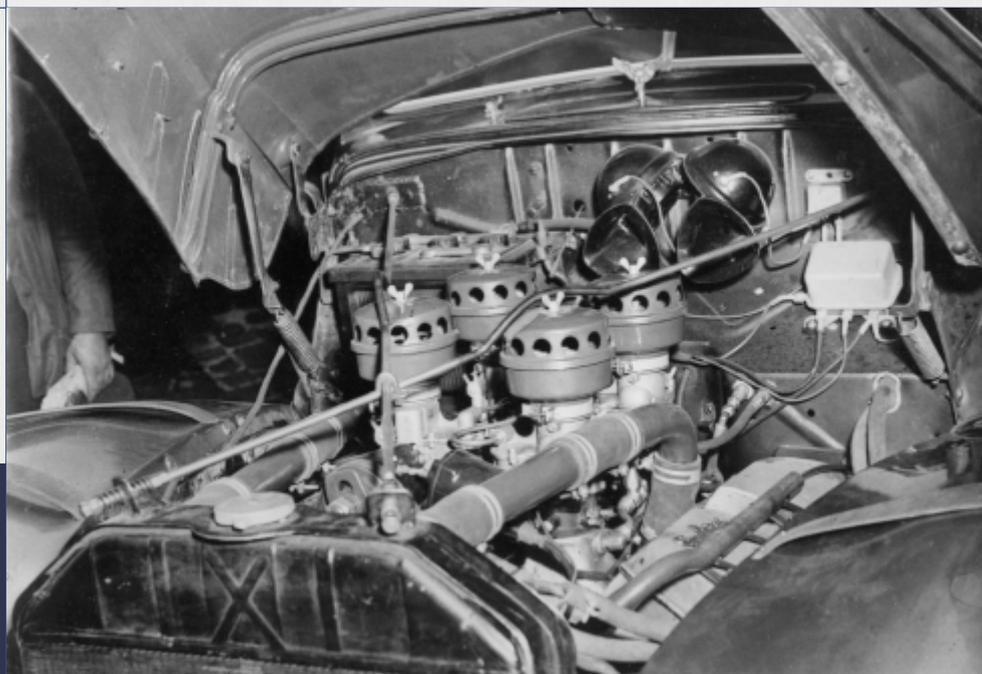
**Este motor funciona por medio de cuatro carburadores del año 1935**, de marca **Stromberg**, de doble cuerpo en la parte interior. Están abastecidos por **tres bombas de nafta**, dos eléctricas y una mecánica de tipo original. Los carburadores están apoyados sobre un **múltiple de cuatro bocas**, marca Ederblock, reformado en su parte interior por los gringos Emiliozzi.
